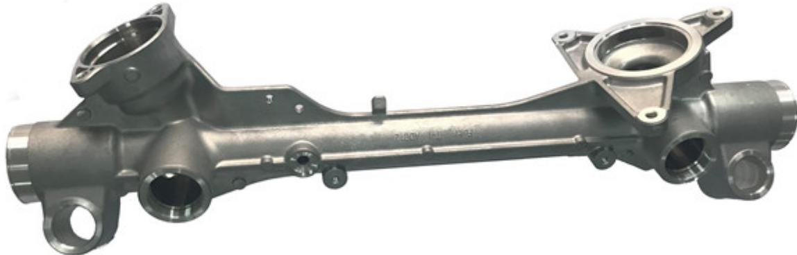
通过大量钢球的滚动接触来传递转向力，具有较大的强度和较好的耐磨性。并且该转向器可以被设计成具有等强度结构，这也是它应用普遍的原因之一。• 变速比结构具有较高的刚度，特别适宜高速车辆车速的提高。高速车辆需要在高速时有较好的转向稳定性，必须保证转向器具有较高的刚度。• 间隙可调。齿条齿扇副磨损后可以重新调整间隙，使之具有合适的转向器传动间隙，从而提高转向器寿命，也是这种转向器的优点之一。中国的转向器生产，除早期投产的解放牌汽车用蜗杆滚轮式转向器，东风汽车用蜗杆肖式转向器之外，其它大部分车型都采用循环球式结构，并都具有一定的生产经验。解放、东风也都在积极发展循环球式转向器，并已在第二代换型车上普遍采用了循环球式转向器。由此看出，中国的转向器也在向大量生产循环球式转向器发展。山东恩斯克转向器壳体模具机械转向器(manual steering gear) 把转向盘的转动变为转向摇臂的摆动，并按一定传动比放大扭矩的机构。
