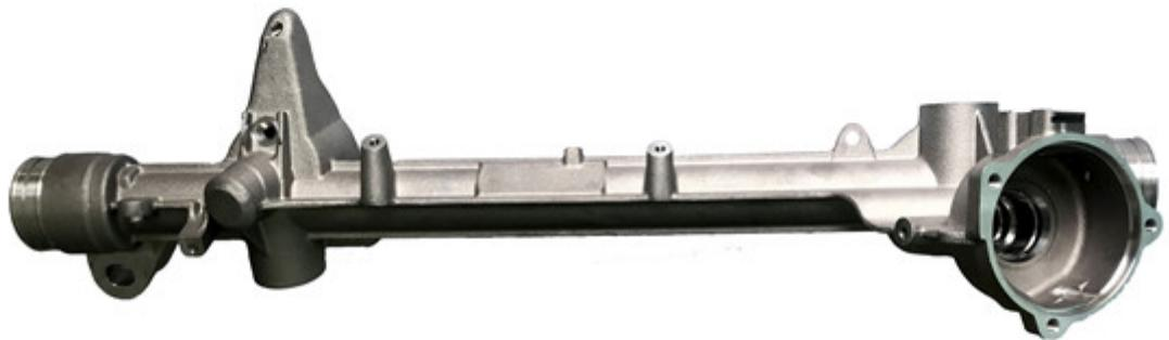
当转动方向盘，转向器根据方向盘转动比例输送相对的油量，该油量直接流到操纵缸相应一侧，同时另一侧的油量回到油箱。BZZ转向器是一种转阀式全液压转向器，具有以下特点：消除机械式联动装置，可以降低主机成本，提供可靠轻便的结构，操纵灵活轻便，安全可靠，可以很小的力矩进行连续无级控制转动，提供给控制回路以及主机尺寸普遍的选择面，能和多种转向油泵及液压供应系统连接。转向器分类转向器按结构形式可分为多种类型。历史上曾出现过许多种形式的转向器，目前较常用的有齿轮齿条式、蜗杆曲柄指销式、循环球-齿条齿扇式、循环球曲柄指销式、蜗杆滚轮式等。其中第二、第四种分别是、第三种的变形形式，而蜗杆滚轮式则更少见。如果按照助力形式，又可以分为机械式(无助力)，和动力式(有助力)两种，其中动力转向器又可以分为气压助力式、液压助力式、电动助力式、电液助力式等种类。
